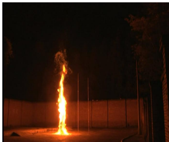
40Kg 桶装硝化棉燃烧实验
