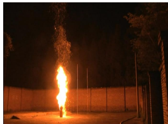
40Kg 桶装硝化棉燃烧实验
